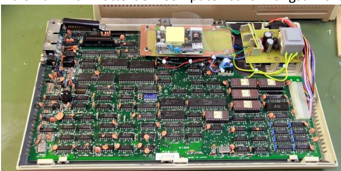
Abb 3: Das Innenleben des Alpatronic PC8 mit Selfmade-Netzteil
